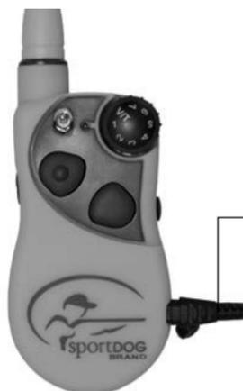
CONNECTEUR DU CHARGEUR PLACÉ DANS LA PRISE DE CHARGEMENT DE L'ÉMETTEUR
